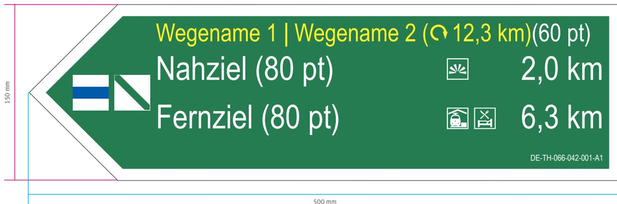
Beispiel 5: Wegweiserschild als rechteckiges Hohlkastenprofil mit aufgedruckter Spitze, ohne Wegename
